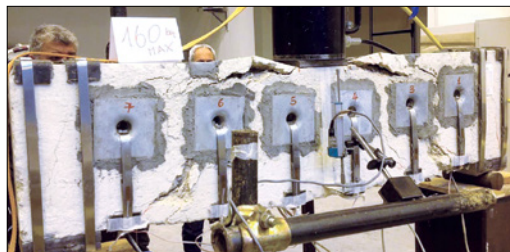
Figura 23 Provino TG P 3N P20_3: configurazione di prova (in alto a sinistra), meccanismo di rottura riscontrato (in alto a destra), legge sperimentale taglio-spostamento (valori medi, in basso a sinistra), confronto fra capacità a taglio stimata e sperimentale (in basso a destra).
