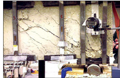
Figura 19 Provino TG T 3N P20_2: configurazione di prova (in alto a sinistra), meccanismo di rottura riscontrato (in alto a destra), legge sperimentale taglio-spostamento (valori medi, in basso a sinistra), confronto fra capacità a taglio stimata e sperimentale (in basso a destra).
