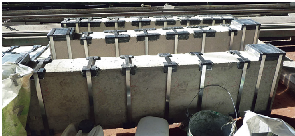
Figura 6 Trave di luce L=145 cm rinforzata con sistema CAM con nastri ad altezza parziale.
