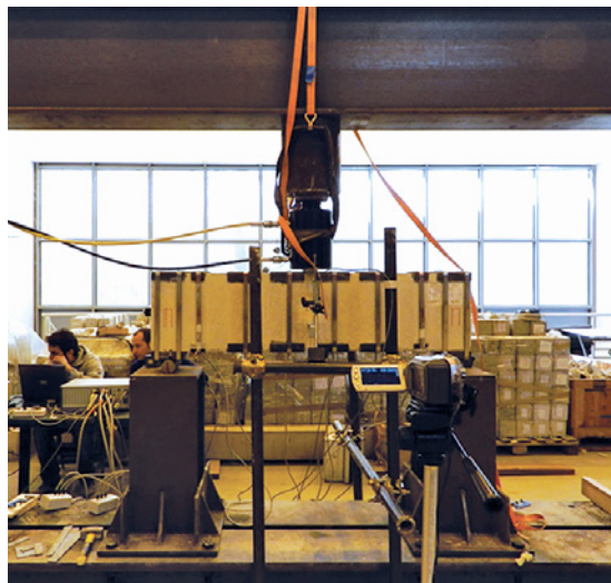
Figura 12 Setup di prova per i meccanismi di taglio (a sinistra) e schemi delle tre tipologie dei provini in c.a. (non rinforzato, rinforzo di intradosso, rinforzo a tutta altezza).
